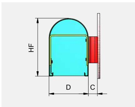
9.4 Mantovana a sbalzo circolare distaccata dalla facciata. Staffe, fissaggio posteriore. Angolo a Z (misura C) 20-50 mm. Lamiera di chiusura fissata. Senza angolari di giunzione.
