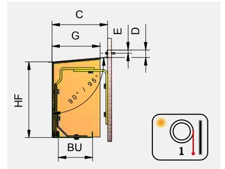
4.1 Mantovana per tettoia con parte inferiore smontabile. Staffe, fissaggio posteriore. Lamiera di chiusura fissata. Possibilità con 90° (profondità C). Possibilità con volte verso il basso (misura D).
