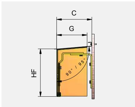
8.1 Mantovana per tettoia. Staffe, fissaggio posteriore. Lamiera di chiusura fissata. Possibilità con 90° (profondità C).
