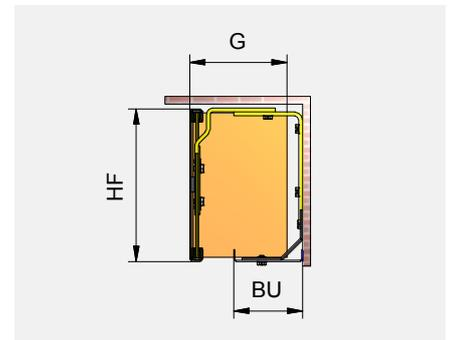
1.7 Mantovana diritta con parte inferiore smontabile. Staffe, fissaggio superiore o posteriore. Lamiera di chiusura non fissata.
