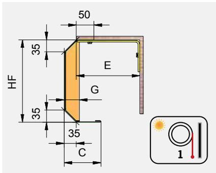
5.4 Mantovana con estremità inferiore e superiore 45°, parte inferiore fissa. Fissaggio superiore o posteriore. Lamiera di chiusura fissata. Senza angolari di giunzione.
