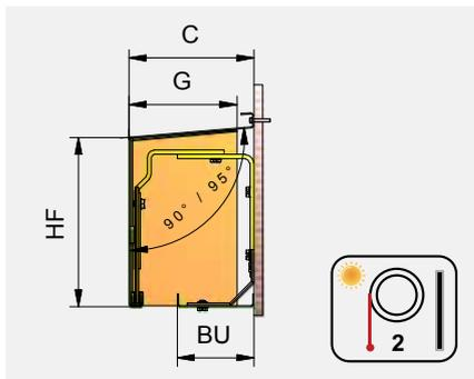
3.1 Mantovana per tettoia con parte inferiore smontabile. Staffe, fissaggio posteriore. Lamiera di chiusura fissata. Possibilità con 90° (profondità C).
