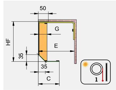
5.3 Mantovana estremità inferiore 45°, parte inferiore fissa. Fissaggio verso l'alto con supporto per cassonetto. Lamiera di chiusura fissata. Senza angolari di giunzione.
