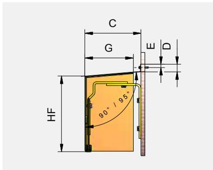
8.2 Mantovana per tettoia sotto il gocciolatoio. Staffe, fissaggio posteriore. Lamiera di chiusura fissata. Possibilità con 90° (profondità C). Possibilità con bordo piegato verso il basso (misura D).
