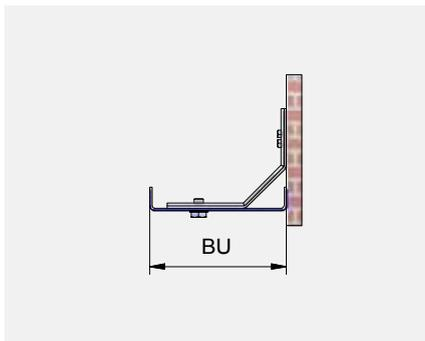
7.1 Parte inferiore a partire da 60 mm. Staffe, fissaggio posteriore. Senza angolari di giunzione.
