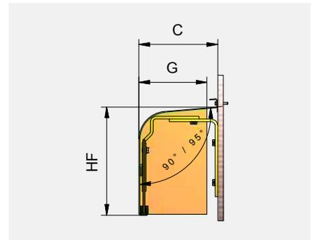
8.3 Mantovana per tettoia semicircolare. Staffe, fissaggio posteriore. Lamiera di chiusura fissata. Senza angolari di giunzione.
