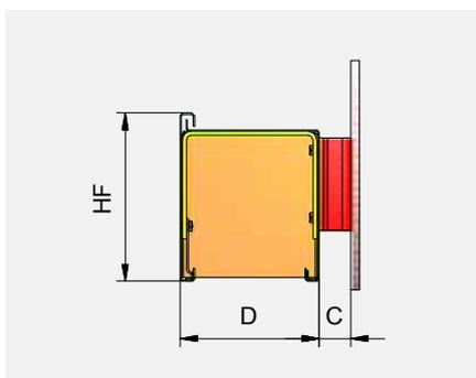
9.1 Mantovana a sbalzo distaccata dalla facciata. Staffe, fissaggio posteriore. Angolo a Z (misura C) 20-50 mm. Lamiera di chiusura non fissata. Senza angolari di giunzione.
