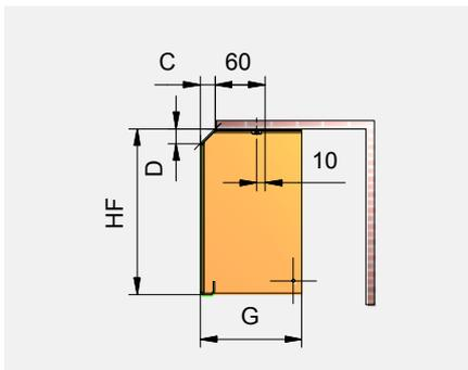
2.1 Mantovana sporgente. Senza staffe, fissaggio superiore. Lamiera di chiusura fissata. Senza angolari di giunzione.
