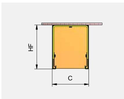
9.2 Mantovana sotto l'incavo del cassonetto. Staffe, fissaggio superiore o posteriore. Lamiera di chiusura fissata. Senza angolari di giunzione.
