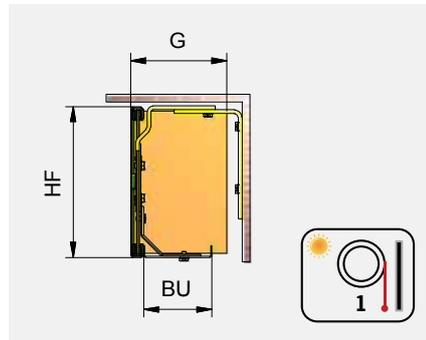
6.1 Mantovana con parte inferiore smontabile. Staffe, fissaggio superiore o posteriore. Lamiera di chiusura non fissata.
