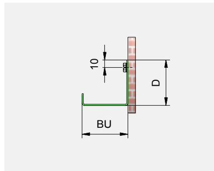
7.2 Parte inferiore fino a 140 mm. Senza staffa, fissaggio posteriore. Senza angolari di giunzione.
