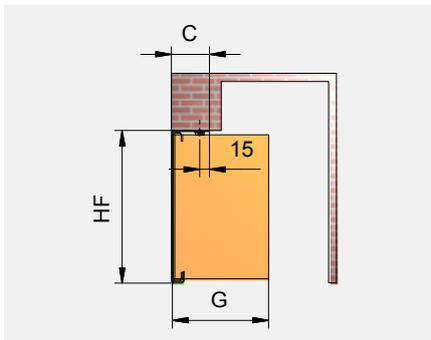
1.5 Allungamento incavo cassetto. Senza staffa, fissaggio superiore. Lamiera di chiusura non fissata.
