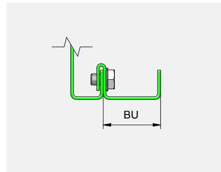
7.3 Parte inferiore da montare. Senza staffa. Senza angolari di giunzione.
