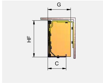
5.2 Mantovana con parte inferiore fissa. Staffe, fissaggio superiore o posteriore. Lamiera di chiusura fissata.
