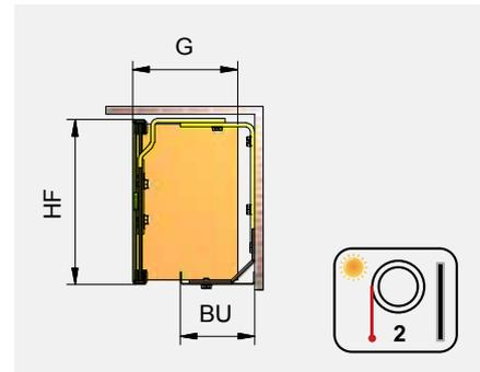
6.2 Mantovana con parte inferiore smontabile. Staffe, fissaggio superiore o posteriore. Lamiera di chiusura non fissata.
