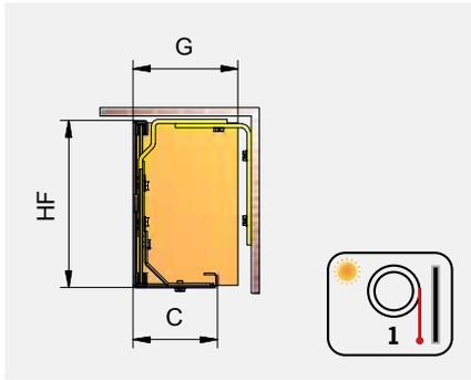
5.1 Mantovana con parte inferiore fissa. Staffe, fissaggio superiore o posteriore. Lamiera di chiusura fissata.
