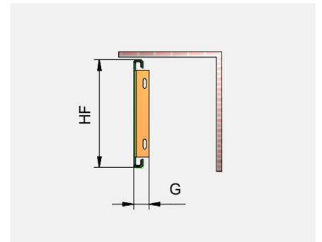
1.4 Mantovana diritta. Senza staffa, fissaggio laterale. Lamiera di chiusura non fissata. Senza angolari di giunzione.
